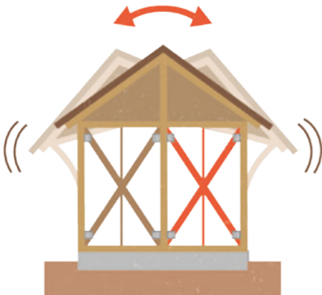
耐震リフォームは、筋交いなどを入れて壁を強化し、柱や梁の接合部を補強するなどがある
